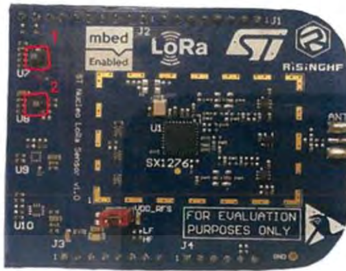
รูป 2.3 เป็นชิพ ST HTS221 และ ST LPS22HB บนบอร์ด LoRa HF band (868/915 MHz) RF and sensor expansion board 4
