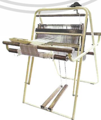
รูปที่ 2.1.10 ภาพตัวอย่างกี่ทอผ้าขนาดเล็ก
