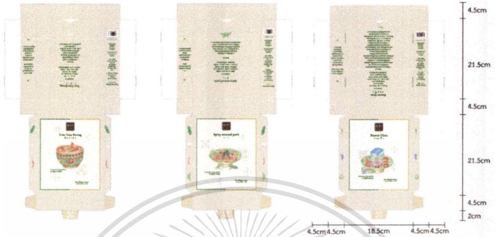
ภาพที่ 4.11 โครงสร้างของบรรจุภัณฑ์ประเทศไทย ขนาดเล็ก
