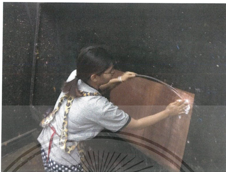
ภาพที่ 3.58 นำแผ่นทองแดงที่ขัดเรียบร้อยแล้วไปล้างน้ำให้สะอาด
