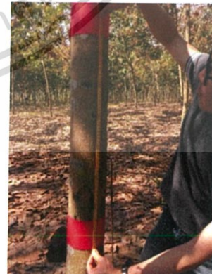
รูปที่ 3.20 ติดตั้งแผ่นเป้าหมายเพื่อให้โปรแกรมตรวจจับระยะห่างเท่ากับ 700 มม.
