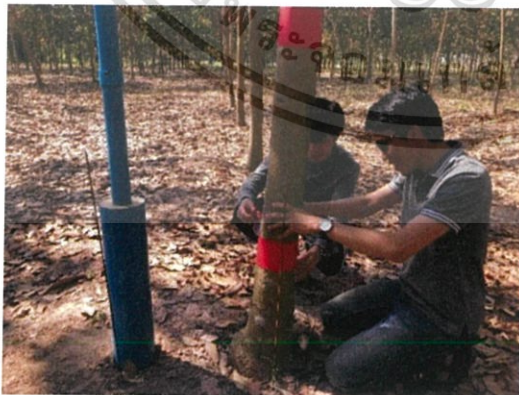
รูปที่ 3.20 ติดตั้งแผ่นเป้าหมายเพื่อให้โปรแกรมตรวจจับระยะห่างเท่ากับ 700 มม.
