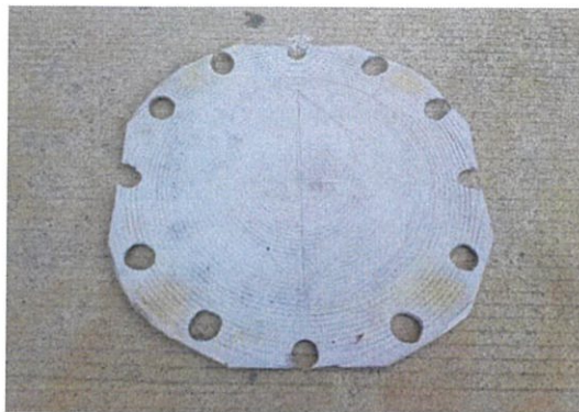
รูปที่ 4.17 แผ่นประลักษ์ที่ทำด้วยแผ่นพลาสติก ABS เมื่อได้ทำการผลิตจริง
