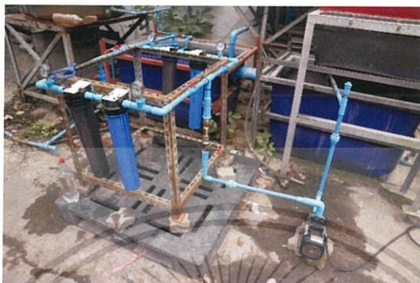
รูปที่ 5.7 ระบบกรองน้ำหลังการปรับปรุงและพัฒนาแล้ว
