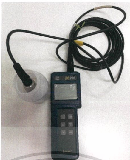
รูปที่ 4.12 อุปกรณ์สำหรับวัดค่าออกซิเจนที่ละลายในน้ำ
