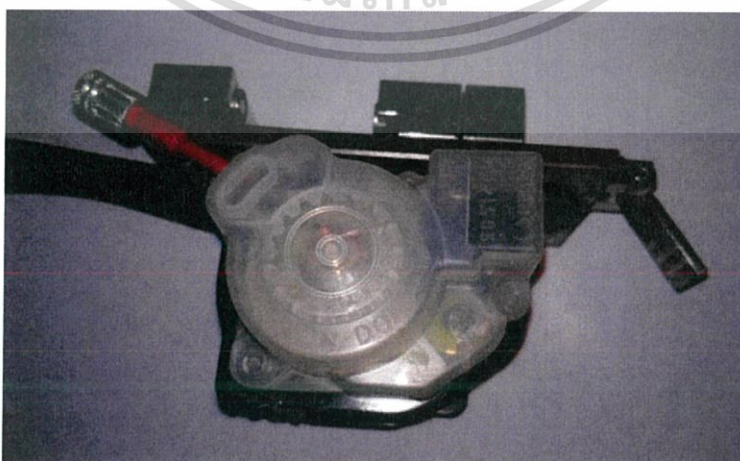
รูปที่ 3.3 กลไกปรับความยาวของสายรัดข้อมือและข้อเท้า
