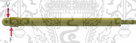
รูปที่ 3.11 แสดงแรงที่กระทำต่อสลักล็อกตำแหน่งบนรางเลื่อนของที่เก็บสายรัด
