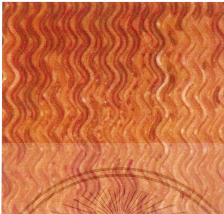
รูปที่ 4.7 แสดงรูปแบบการไหลแบบ bubbly flow
