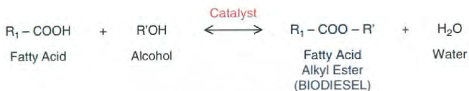
รูปที่ 2.10 การผลิตไบโอดีเซลโดยอาศัยปฏิกิริยา esterification
