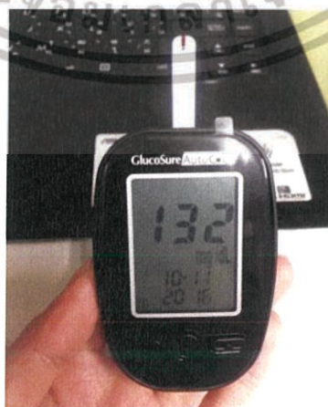
รูปที่ 3.7 การแสดงค่าความเข้มข้นสารละลายกลูโคสของเครื่อง Glucosure
