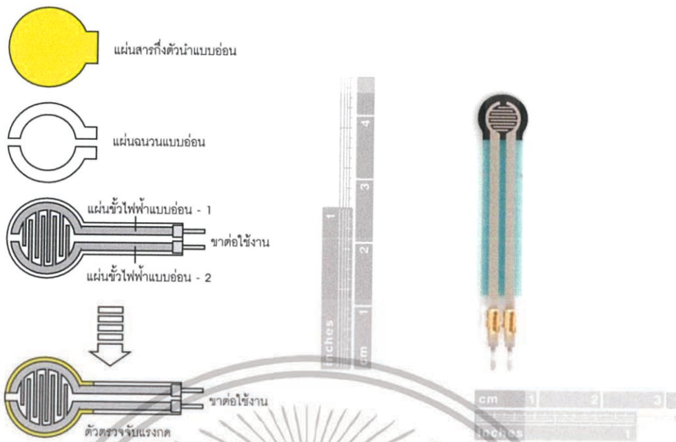
รูปที่ 2.16 โครงสร้างตัวตรวจจับแรงกดและขนาดจริงของตัวตรวจจับแรงกด
