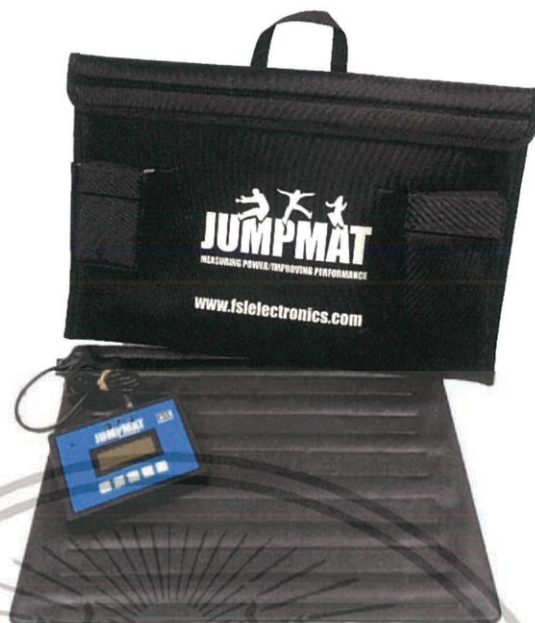
รูปที่ 2.14 เครื่องวัดการกระโดดสูงในแนวตั้งแบบแผ่นเหยียบ
