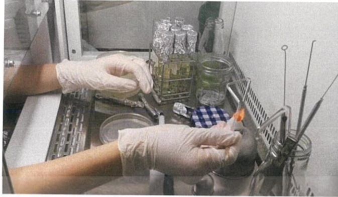
รูปที่ 73 นำ glass spreader ไปลงไฟ
