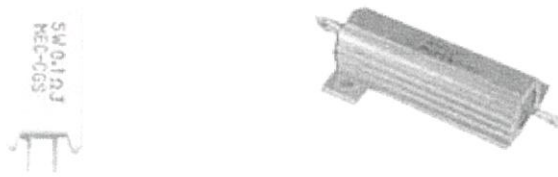
(ง) ประเภทเซรามิกไวร์วาวด์ (จ) ประเภทอลูมิเนียมไวร์วาวด์
