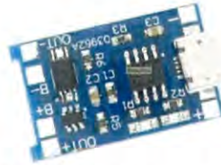
รูปที่ 3.9 โมดูลชาร์จแบตเตอรี่ลิเทียม (Lithium charger module)
