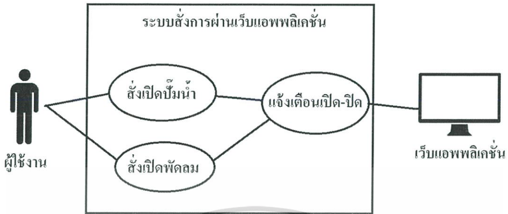
รูปที่ 3.2 Use case diagram ของระบบสั่งการผ่านเว็บแอปพลิเคชัน
