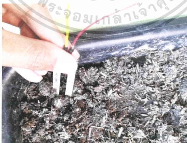
รูปที่ 4.8 วัดความชื้นในดินด้วยอุปกรณ์รับรู้วัดค่าความชื้นในดิน (YL69)
