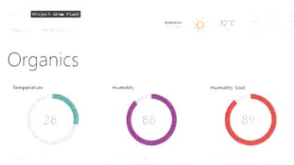
รูปที่ 4.12 ปั้มน้ำที่จ่ายน้ำให้กับผักออแกนิกจะถูกปิดหากค่าความชื้นในดินมีค่า \geq 80\%
