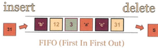
รูปที่ 2.5 ลักษณะการทำงานของการเข้าคิวแบบ FIFO
