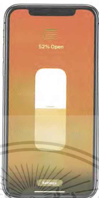
รูปที่ 4.4 การปรับระดับม่านผ่านแอปพลิเคชัน
