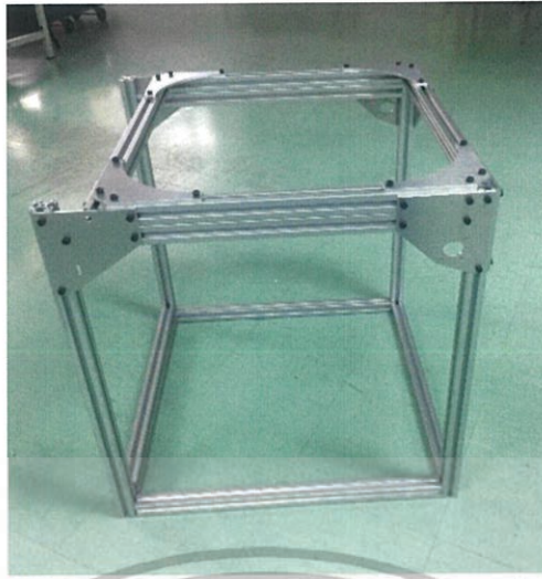
รูปที่ 3.11 การประกอบเพื่อเสริมความแข็งแรงโครงสร้าง
