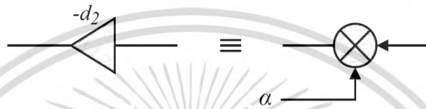
รูปที่ 6.3 โครงสร้างในส่วนของที่ค่าสัมประสิทธิ์ d_1 ที่สามารถปรับจูนได้
