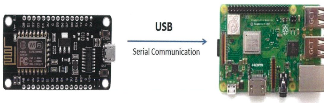
รูปที่ 3.8 การเชื่อมต่อระหว่าง NodeMCU กับ Raspberry Pi 3 Model B+
