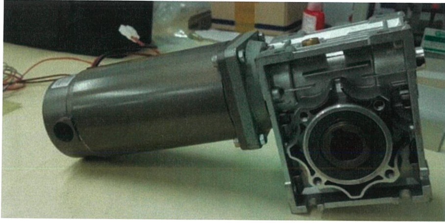
รูปที่ 3.120 การประกอบมอเตอร์เข้ากับชุดเกียร์
