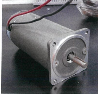
รูปที่ 3.5 มอเตอร์ดีซี ZYT – 90S 24 โวลต์ 500 วัตต์
