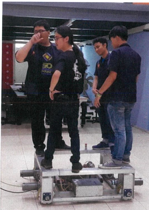
รูปที่ 5.1 การทดสอบความแข็งแรงโดยการให้คนไปยืนจำนวน 4 คน
