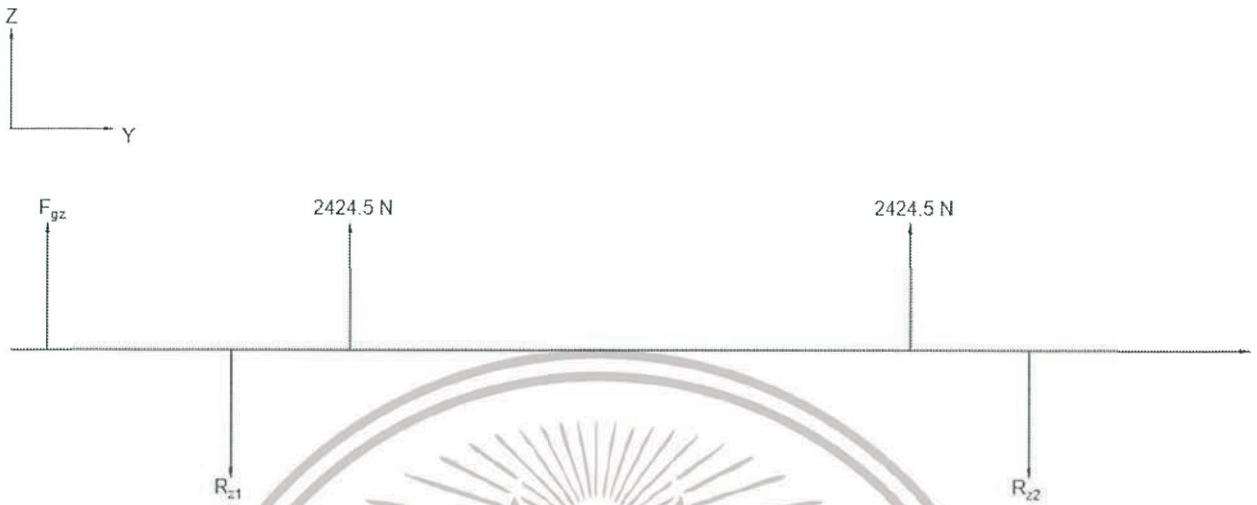
รูปที่ ก 13 free body diagram ของเพลาในระนาบ X-Y
