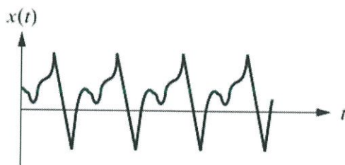
รูปที่ 2.3 ลักษณะการเคลื่อนที่ของการสั่นสะเทือนที่เป็นรอบ [3]
