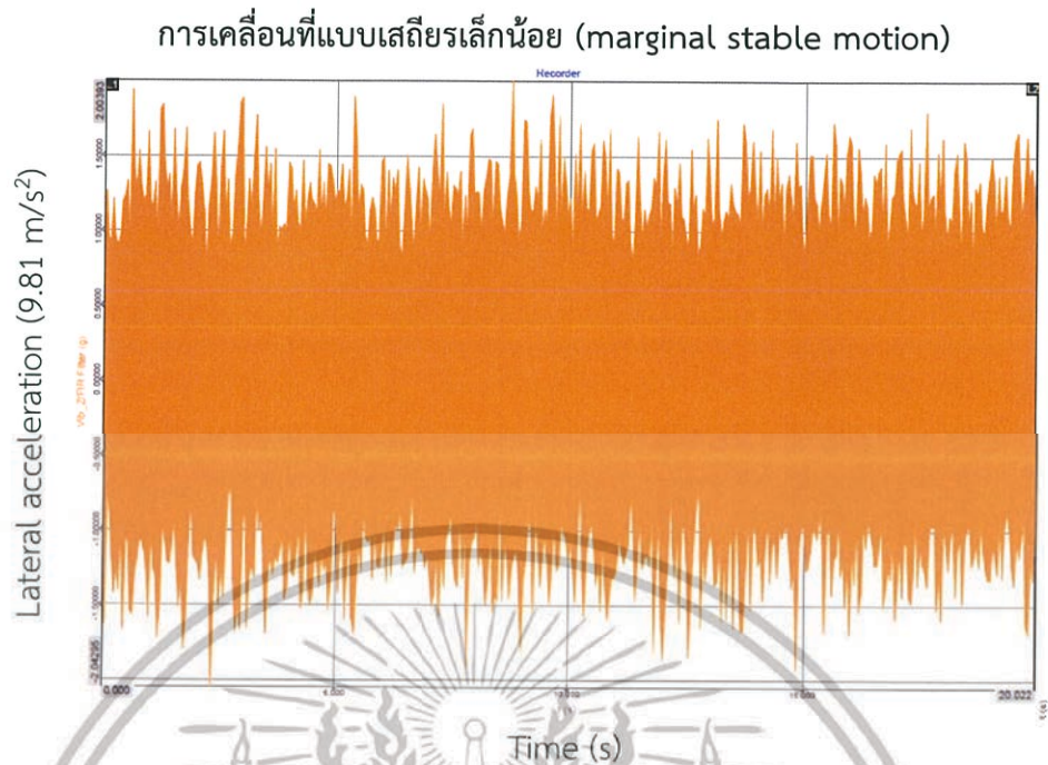
รูปที่ 4 . 18 กราฟแสดงผลของความเร่งตอบสนองของชุดเพลาล้อ 1/40 ที่ความถี่กระตุ้น 19.78 Hz (1187 RPM) คำนวณค่าความเร็วได้ 9.32 m/s
