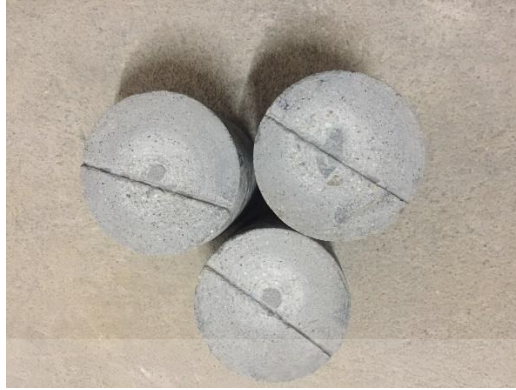
รูปที่ 3.16 ตัวอย่างสำหรับทดสอบ จำลองการวิบัติ (0.2x0.2x10 ซม.)
