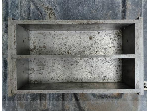
รูปที่ 3.9 ชุดแบบหล่อตัวอย่างทดสอบการหดรวมของคอนกรีต
