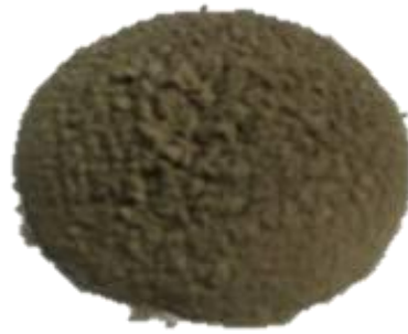
รูปที่ 3.2 ถ้ำลอยจากโรงไฟฟ้าบีแอล ซี พี เพาเวอร์ จำกัด
