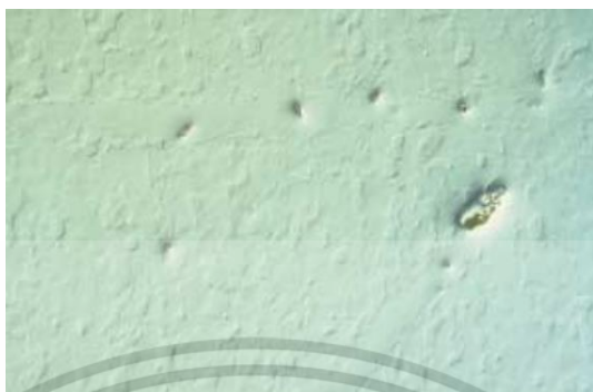
รูปที่ 2.27 การเกิดตำหนิแบบ Lapping Tracks ของชิ้นงาน กำลังขยาย 500 เท่า [24]
