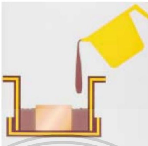
รูปที่ 2.13 ตัวอย่างการทำตัวเรือนแบบเย็น [24]
