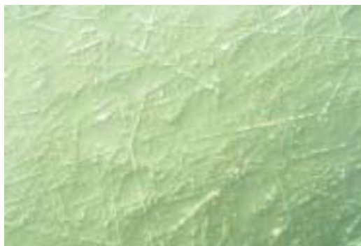
รูปที่ 2.16 ลักษณะแนวเส้นของการเสียรูป กำลังขยาย 200 เท่า [24]
