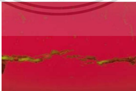
รูปที่ 2.22 รอยแตกที่เกิดขึ้นจากการเตรียมขึ้นงาน กำลังขยาย 500 เท่า [24]
