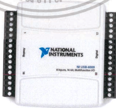
รูปที่ 2.13 เครื่องจัดเก็บข้อมูลและแปลงสัญญาณ DAQ (Data Acquisition)
