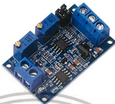
รูปที่ 2.14 Voltage to Current Converter Module 1-5V to 0-20 mA
