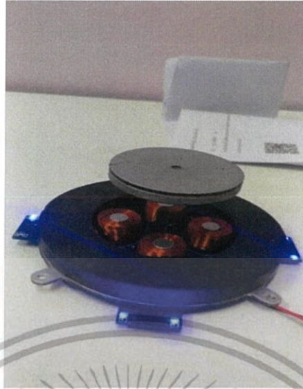
รูปที่ 4.14 ตัวแสดงผลชนิดแม่เหล็กเหนียวนำ
