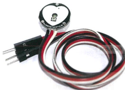
รูปที่ 3.2 เซนเซอร์วัดอัตราการเต้นของหัวใจ
