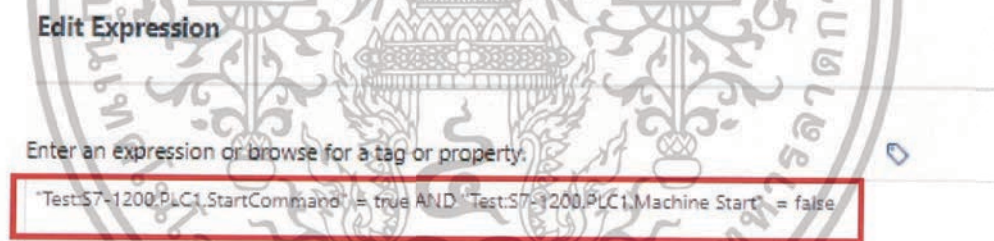
รูปที่ 3.83 เขียนเงื่อนไขสถานะ Unplanned Downtime
