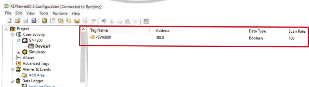
รูปที่ 3.53 การ Configuration ใน KepserverEx เพื่อเชื่อมต่อ PLC
