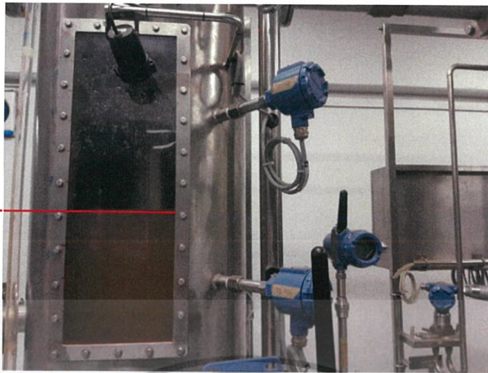
รูปที่ 4.4 ค่าของระดับน้ำที่วัดได้จาก Guide Wave Radar
