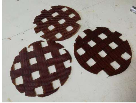
รูปที่ 3.2 วัสดุเสริมแรง RSS-geogrid สำหรับการทดสอบ CBR
