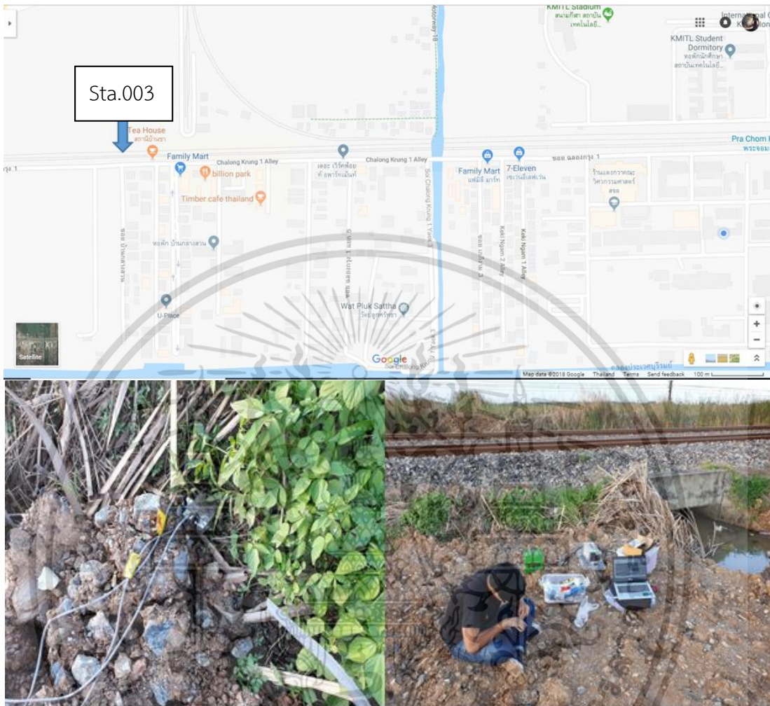
รูปที่ 4-11 ภาพแสดงสถานีทดสอบที่ 3 sta.003 รางรถไฟหน้าหอพัก RNP ระหว่างสถานีพระจอมเกล้า-สถานีบ้านทับช้าง ทำการวัดโดยการติดตั้งหมุดในดินใกล้กับรางรถไฟ ระยะห่าง 2.778 เมตร
