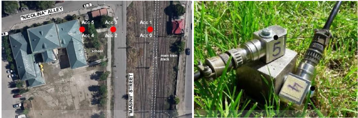
รูปที่ 2-25 ภาพแสดงตัวอย่างการวัดความเร่งของพื้นดินในบริเวณใกล้กับแนวรางรถไฟ ที่มา OANCEA[55]
