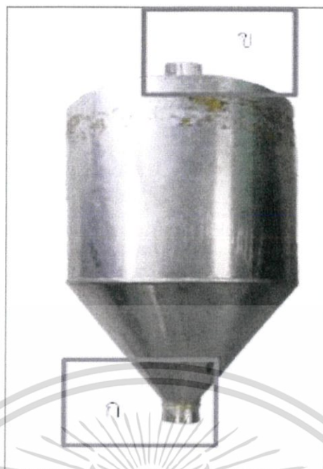
รูปที่ ค.1.5 ช่องอากาศของถังหมัก ก. ช่องอากาศขาเข้าถังหมัก ข. ช่องอากาศขาออกถังหมัก
