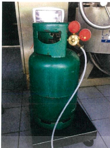
รูปที่ 4.15 ชั่งน้ำหนักแก๊สที่ใช้ต่อหนึ่งกระบวนการ
