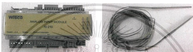
รูปที่ 4.8 ก. คาร์ด้าล็อกเกอร์ wisco AI20 ข. เทอร์โมคัปเปิล Type k
