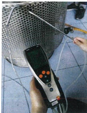
รูปที่ 4.7 pitot tube manometer Testo 435 Series
