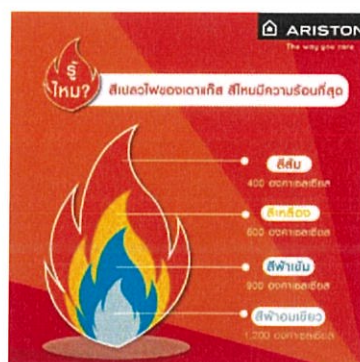
รูปที่ 2.2 อุณหภูมิแต่ละช่วงสีของเปลวไฟ
