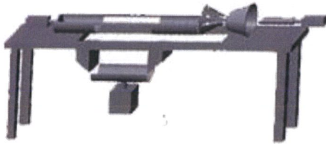
รูปที่ 2.10 เครื่องปอกเปลือกสับปะรดและเอาแกนออก ที่มา: (Shinde 2017)
