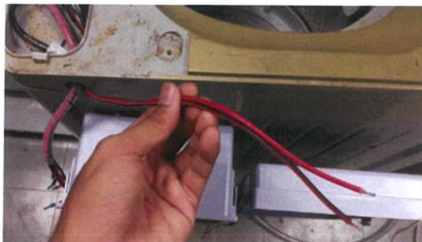
รูปที่ 3.10 สายควบคุมวาล์วน้ำเข้าและสายควบคุมวาล์วน้ำออกที่ตัดแล้ว
