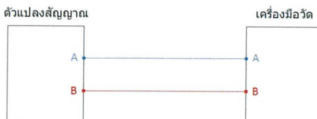
รูปที่ 2.5 การเชื่อมต่อ RS-485 ระหว่างเครื่องมือวัดกับตัวแปลงสัญญาณ
