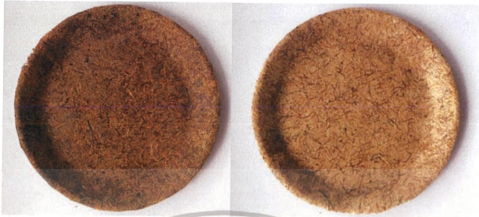
รูปที่ 4.3 เส้นใยผลปาล์มหลังจากอัดขึ้นรูปเป็นภาชนะจาน (ซ้าย) จานที่อัดโดยใช้เส้นใยที่ไม่ได้ฟอกสี (ขวา) จานที่อัดโดยใช้เส้นใยที่ฟอกสี
