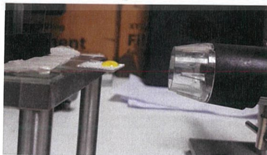
รูปที่ 3.6 ลักษณะการถ่ายหยดสารละลายอีพอกซีเรซินเพื่อวัดมุมสัมผัส
