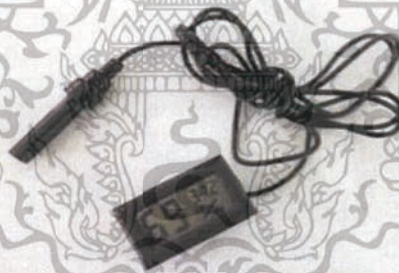
รูปที่ 3.2 เครื่องวัดอุณหภูมิและความชื้นดิจิตอล
