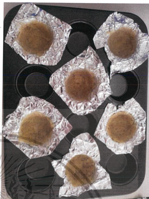
รูปที่ 3.14 เทของผสมลงในแม่พิมพ์ อลูมิเนียมที่รองด้วยแผ่นฟอยล์อลูมิเนียม
