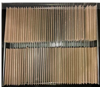
รูปที่ 3.3 การจัดเรียงเพรสบอร์ดเพื่อเตรียมสำหรับการอิมเพรกเนต
