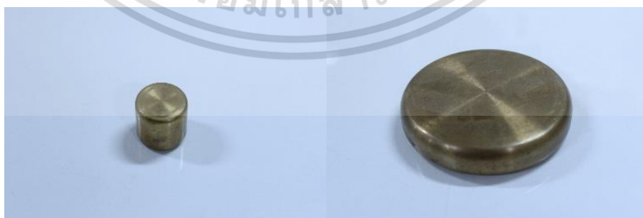
รูปที่ 3.1 อิเล็กโตรดชุดทดสอบค่าความคงทนต่อแรงดันเบรกดาวน์ของเพรสบอร์ด
