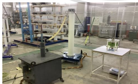
(ข) วงจรทดสอบการวัดค่าความคงทนต่อแรงดันไฟฟ้ากระแสสลับของเพรสบอร์ด
