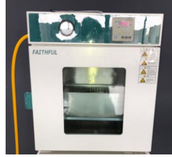
(ก) การเตรียมอิมเพรกเนตด้วยฉนวนเหลือง (ข) เพรสบอร์ดที่ถูกอิมเพรกเนตในตู้อบ
