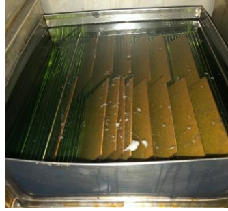
(ก) การเตรียมอิมเพรกเนตด้วยฉนวนเหลือง (ข) เพรสบอร์ดที่ถูกอิมเพรกเนตในตู้อบ
