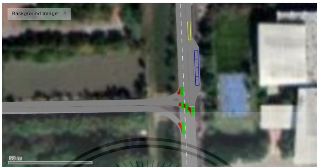
รูปที่ 4-27 แบบจำลองเพิ่มช่องจอดรถโดยสาธารณะขนาดที่ 3 ความยาว 24 เมตร
