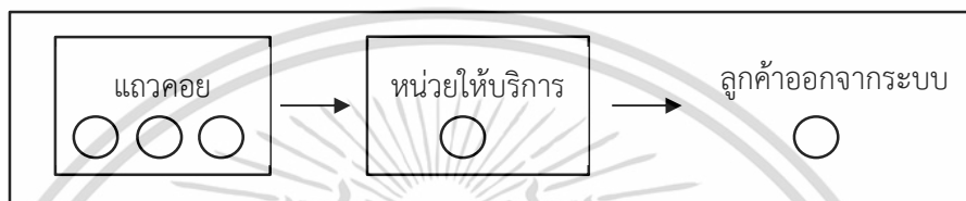
รูปที่ 2.2 ระบบแถวคอยที่มีขั้นตอนเดียว มีแถวคอยแถวเดียว และมีหน่วยบริการ 1 หน่วย (Single-Channel-Single-Phase System)
