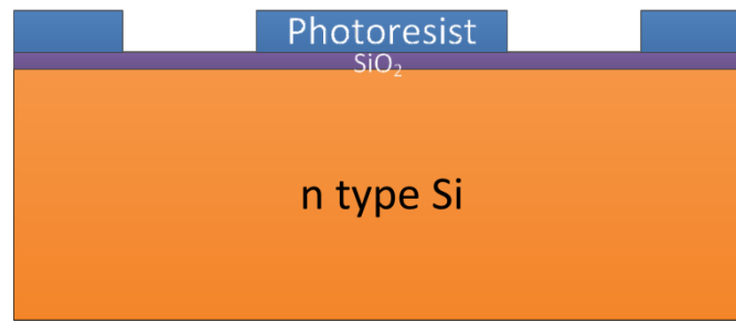
รูปที่ 3.9 การลอกน้ำยาไวแสง (Photoresist) ออกจากผิวซิลิคอนออกไซด์
