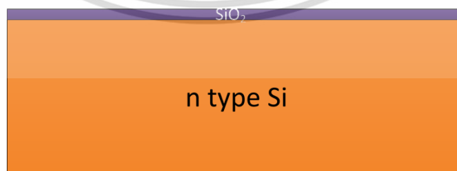
รูปที่ 3.5 ภาพตัดขวางการสร้างพื้นผิวซิลิคอนออกไซด์ลงบนฐานรองซิลิคอน
