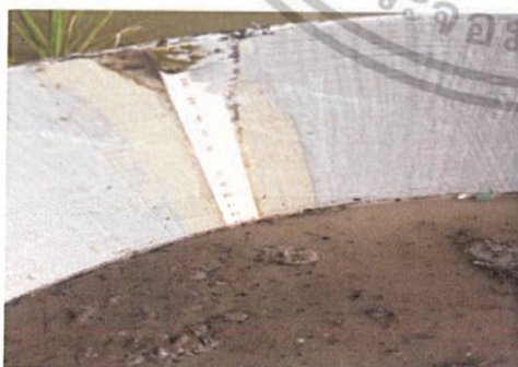
รูป 3.20 สเกลในการวัดของ Lysimeter
